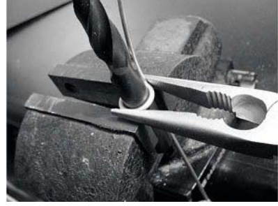
شكل 4.18: لف السلك حول ريشة المثقب لصنع لفة.
