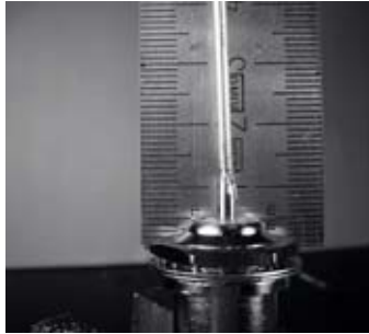
شكل 4.40: يشكل طول السلك عاملاً فائق الأهمية في تحديد أداء الهوائي.
