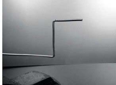
شكل 4.17: ثني السلك على شكل حرف Z.
