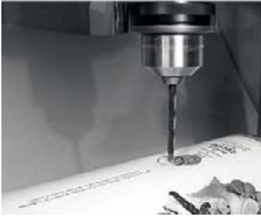
شكل 4.37: إحفر الثقب بعناية وبتدرج حتى تحصل على حجم الفتحة المطلوب.
