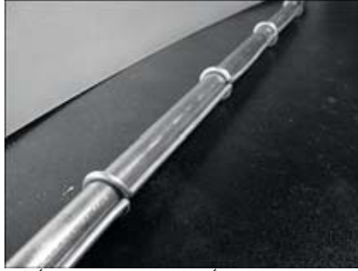
شكل 4.21: يساعد إدخال الأنبوب على جعل السلك أكثر استقامة.
