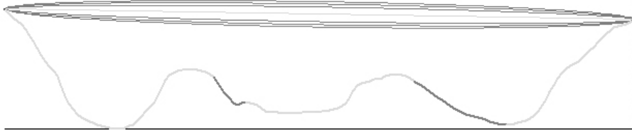
شکل 3.9: جدوى الوصلة، وتظهر على الشكل أيضاً منطقة فرانيل الأولى وتخمين خط النظر باستخدام برنامج RadioMobile.
