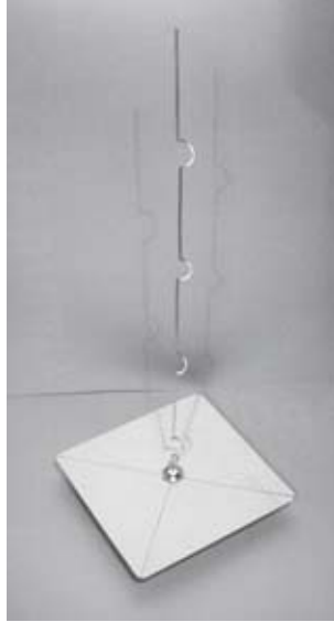
شكل 4.30: ينبغي أن يبلغ طول الهوائي المكتمل 42.5 سم من سطح الصفيحة وحتى نهاية السلك.
