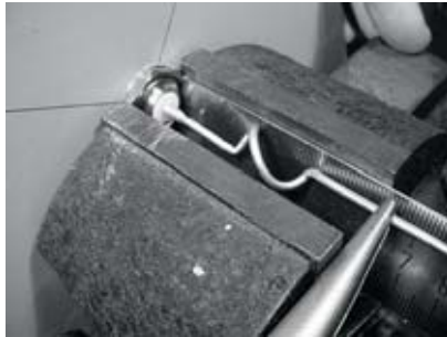
شكل 4.28: شد اللفات. حاول القيام بذلك بلطف وتجنب تجريح سطح السلك بالكماشة.
