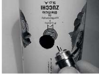
شكل 4.37: إحفر الثقب بعناية وبتدرج حتى تحصل على حجم الفتحة المطلوب.
