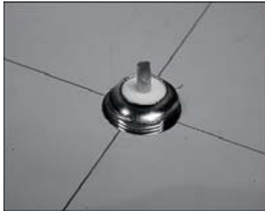
شكل 4.23: ينبغي أن يتلاءم حجم ثقب الصفيحة تماماً مع حجم المقبس N.
