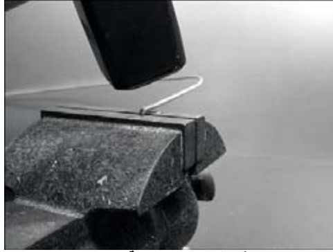
شكل 4.16: قم بثني السلك بعناية لصنع انحناء حاد.
