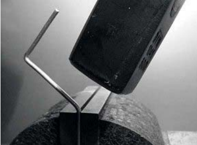
شكل 4.17: ثني السلك على شكل حرف Z.
